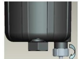
拧松放水阀，将水放尽，然后拧紧放水阀
